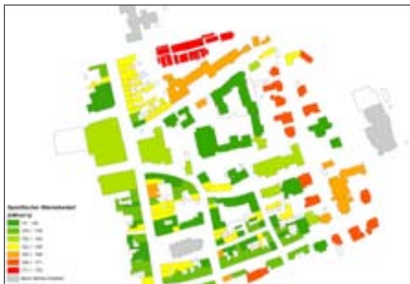
Abb. 6 | Differenzierter spezifischer Wärmebedarf der Gebäude im Quartier
