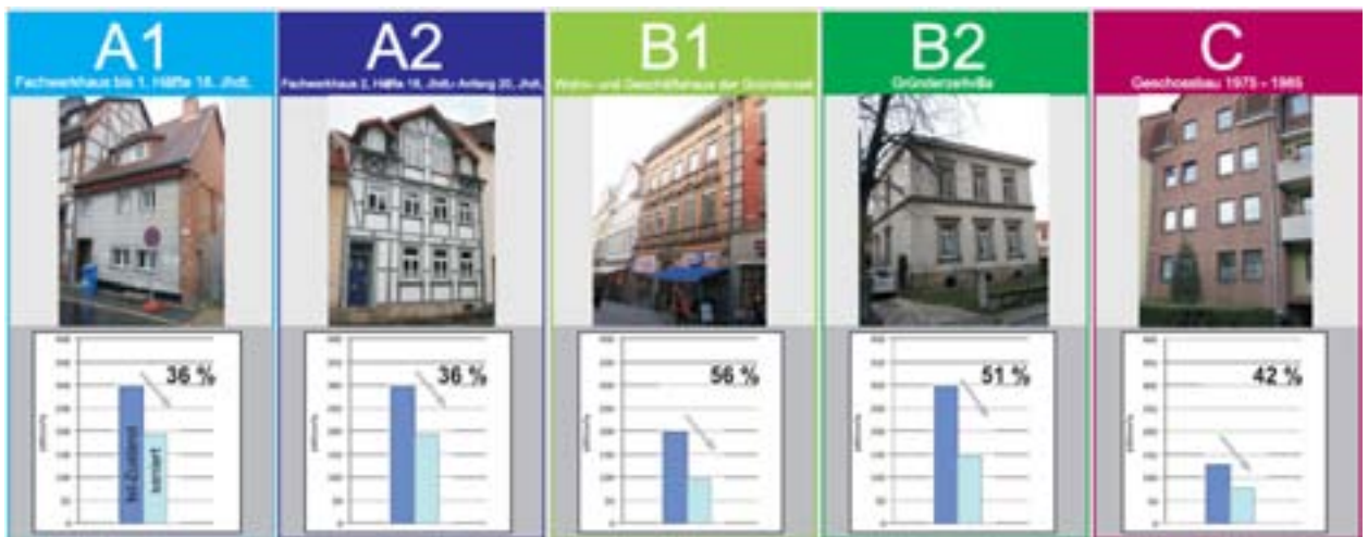
Abb. 5 | Typisierte Gebäude und Energieeinsparpotenziale durch Verbesserung der Gebäudehülle bei Wahrung der baukulturellen Integrität der Gebäude
